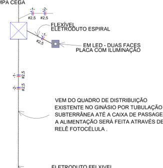
DEM DO QUADRO DE DISTRIBUIÇÃO EXISTENTE NO GINÁSIO POR TUBULAÇÃO SUBTERRÂNEA ATÉ A CAIXA DE PASSAGEM. A ALIMENTAÇÃO SERÁ FEITA ATRAVÉS DE RELÉ FOTOCÉLULA.
